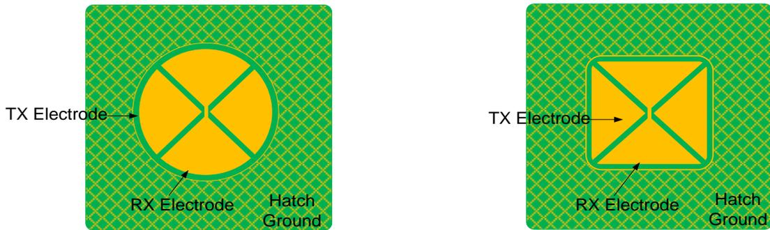
对于较厚的覆盖层 (> 1.5 mm)，按键为大尺寸，在这种情况下，建议增加 Tx 和 Rx 段的数量，如图 7-9 所示。这样会增加各电极间的耦合，并且手指触摸传感器时，会增加信号。
