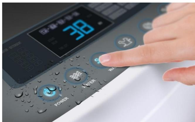
为了能补偿薄雾、湿气和湿度变化所导致的原始计数化，CapSense 感应方法连续调整传感器的基准线，以防止发生误触摸。要想补偿原始计数因液滴或水流导致的变化，用户应该安装一个屏蔽电极和保护传感器，以提供强大的触摸感应功能，如图 2-20 所示。当安装屏蔽电极时，即使传感器表面上存在水滴，CapSense 仍能正常工作并报告传感器的 ON/OFF 状态。存在水流时，保护传感器将检测是否存在水流，并不扫描传感器。因此，也不会报告传感器的 ON/OFF 状态。
